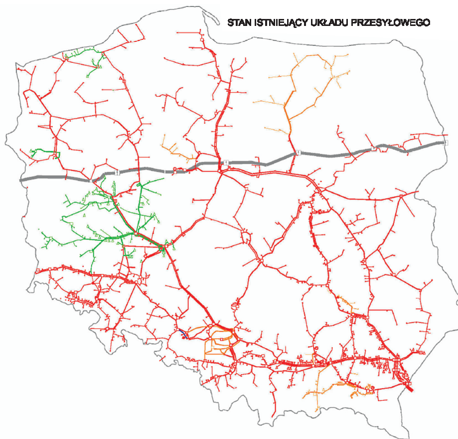
Ryc. 5.1. Krajowy system przesyłu gazu: gazociąg tranzytowy (czarny), gazociągi wysokiego ciśnienia (czerwone i zielone) w 2005 roku
